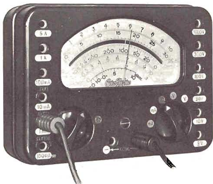
Colocando un espejo detrás de la escala, pueden efectuarse lecturas más precisas.
