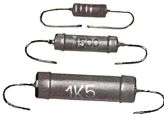
Para un mismo valor óhmico, la potencia de disipación puede ser mayor cuando la resistencia es de mayor tamaño.
