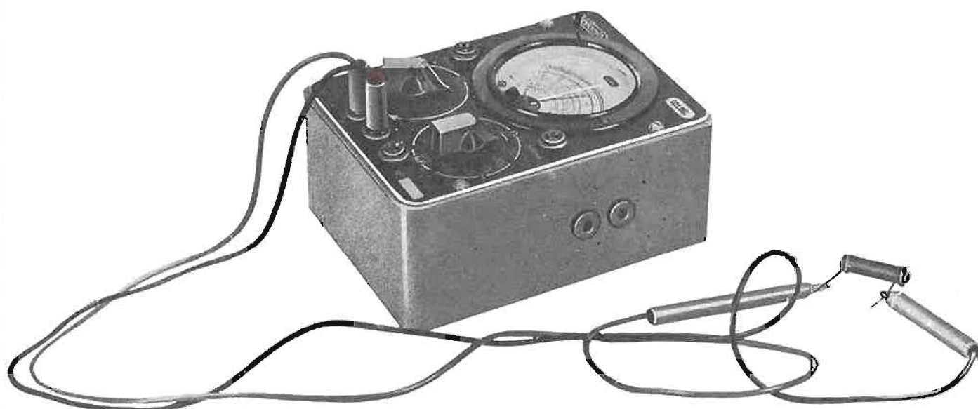
Aspecto de un comprobador o analizador universal. El botón flecha de la izquierda sirve para el ajuste a cero del óhmetro. Con el de la derecha se escoge la gama de medición que debe utilizarse. La resistencia que se supone medir está intercalada entre dos puntas de prueba.
