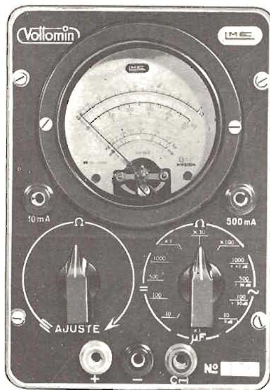
Aspecto de un polímetro. Fijese en las escalas en que se marcan las diversas graduaciones que corresponden a sus diversas posibilidades y gamas de medición.
