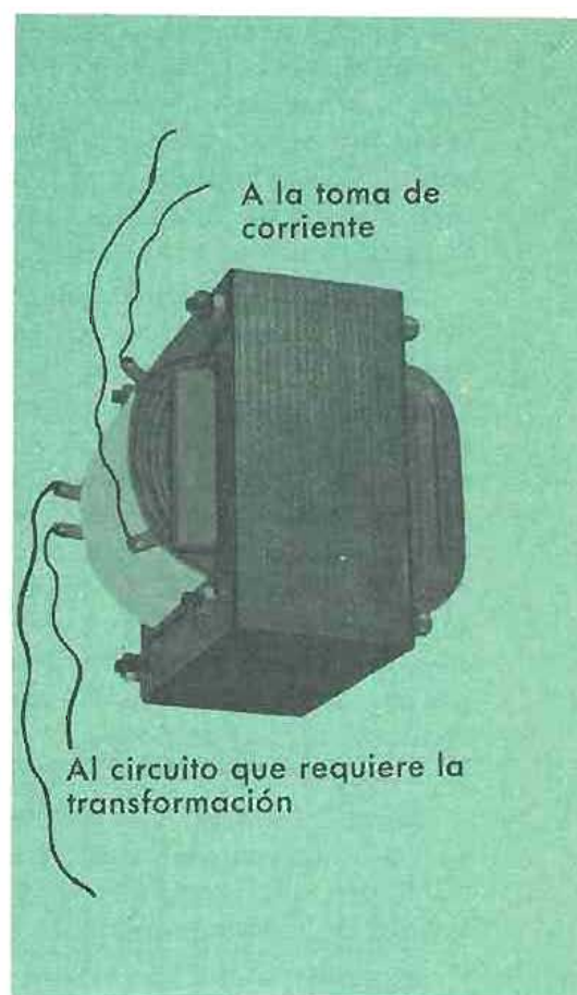
Carrete, hilo de cobre y chapas magnéticas, son el material básico para la construcción de un transformador. Una vez bobinados el primario y secundario, se introduce el núcleo en el interior del carrete alternando la posición de las chapas.
