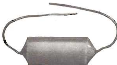
Condensador de 20 K pF (20.000 pF.)
